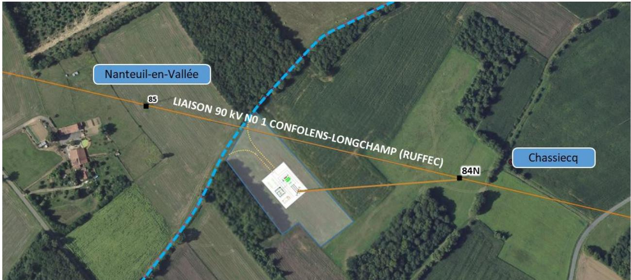
Plan du raccordement envisagée : création d'une portée aérienne de 180 mètres raccordée en piquage aérien sur la ligne aérienne à 90 000 volts Confolens- Longchamps
